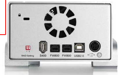
Taurus RAID Rückwärtig unter dem Lüfter liegen die FW-800-, FW-400- und USB-Schnittstellen
