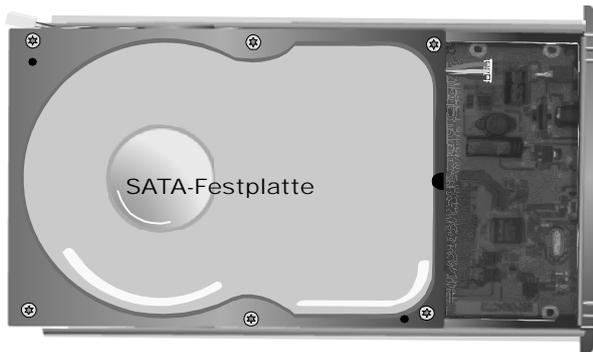
Finden Sie die beigelegten Schrauben. Vergewissern Sie sich, dass die Schraubenführungen auf der Unterseite der Festplatte mit den Öffnungen auf der Unterseiten des Festplattenrahmens ausgerichtet sind. Befestigen Sie die Festplatte durch Einfügen und Anziehen der Schrauben am Festplattenrahmen.
