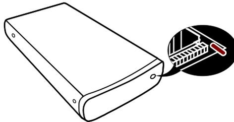
8. Réassemblez la baie en remplaçant les deux vis retirées à l'étape 1.
