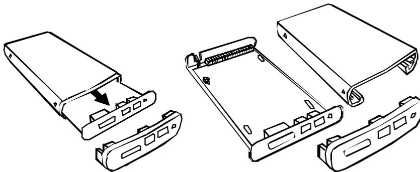
3. Retirez la vis du panneau de contrôle en desserrant les capuchons en plastique.
