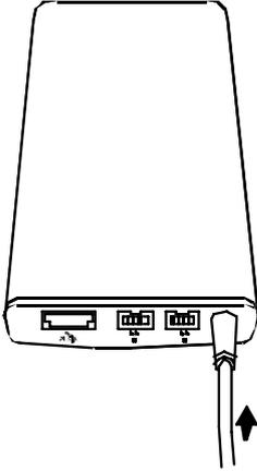
2. Insérez le connecteur eSATA, USB ou IEEE 1394a (b) dans le port correspondant.
