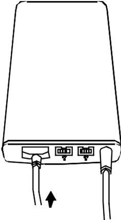
Le connecteur eSATA/USB 2 en 1 DuoLink combine la connectivité eSATA et USB 2.0 sur un seul port. DuoLink s'adapte aux connecteurs USB et eSATA. Pour transférer des données via la connexion USB, connectez un câble USB au boîtier. Pour transférer des données via eSATA, connectez un câble eSATA au boîtier.
