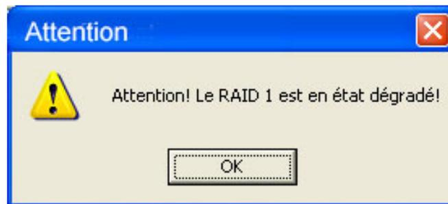
3. L'option "Reconstruction" devrait ensuite apparaître. Continuer en remplaçant le disque défaillant par un neuf ou insérez un nouveau disque pour remplacer l'ancien. Le nouveau disque sera marqué en rouge comme « New » (nouveau) et « Not Config » (non configuré). Pour reconstruire ce nouveau disque avec les données du disque remplacé ou retiré, cliquez sur le bouton « Reconstruction ». L'unité RAID s'appuiera alors sur le disque sain restant pour achever la Reconstruction.
