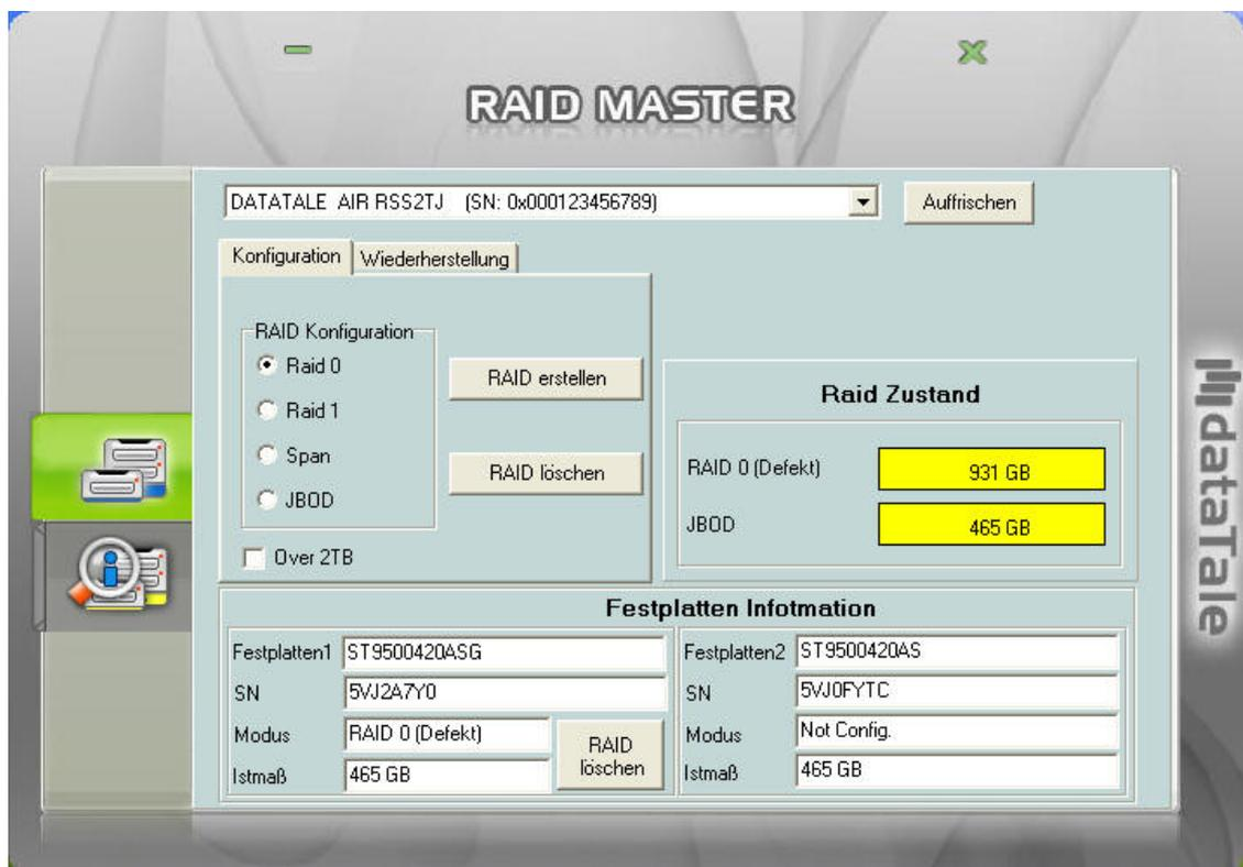
2. Um die vorgängige Formatierung der neu eingesetzten Festplatte zu ändern, drücken Sie „RAID löschen“ unter „Festplatten Information“.
