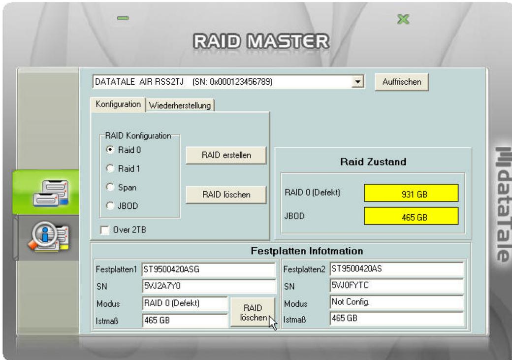
3. Nachdem dieser Prozess abgeschlossen ist kann die neue Festplatte als JBOD oder mit der bestehenden Festplatte in einem RAID Verbund genutzt werden.
