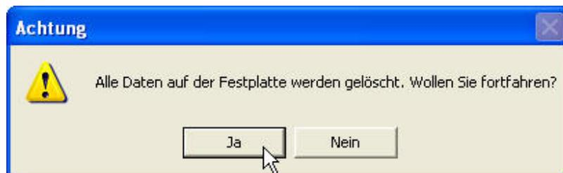
3. Die RAID MASTER Software wird nun den gewählten RAID Modus auf die Festplatten übertragen. Sobald der Prozess abgeschlossen ist, sollten „RAID Status“ und Festplatteninformation“ den neuen RAID Modus anzeigen. Sie können nun das RAID System mit dem gewünschten RAID Modus in Betrieb nehmen!
